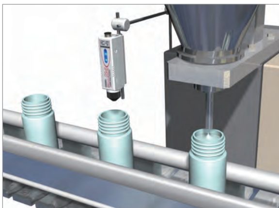
液体や粉体の充填ラインでの除電
