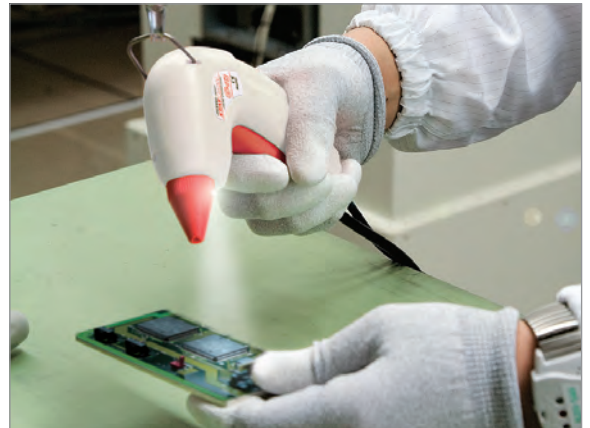
基板の除電・除塵
