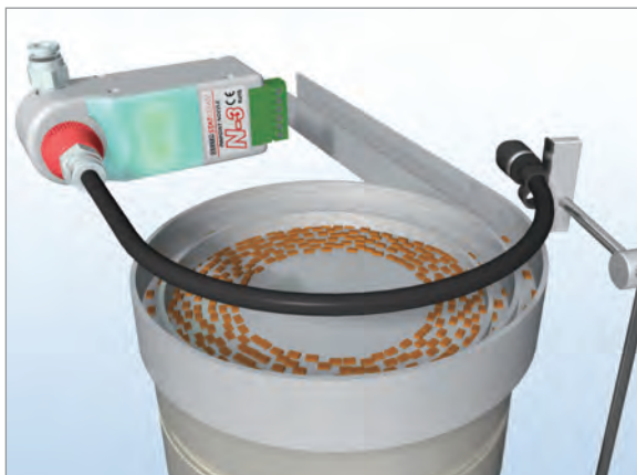
パーツフィーダの除電(継手ノズル+シャワーチューブ)
