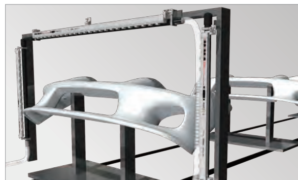
塗装工程前の除電除塵
