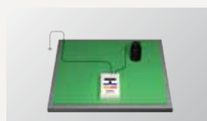
接地/接地可能接続点間抵抗の測定
