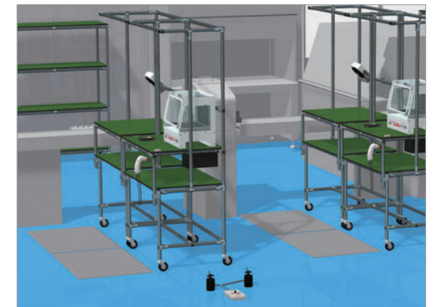
静電気対策エリア
