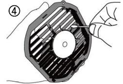
※放電針の折れ・脱落、除電性能が戻らない、取り付けにガタつきなどがある場合は、新しいフロントカバーに交換してください。
