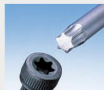
基本形状は、6つの耳たぶ状曲線で構成されています。六角頭に比べ駆動効率が高く、確実なトルク伝達とカムアウトが解消されます。
