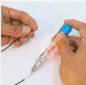
配線回路の導通チェック。(50MΩ以下の回路に限りです。) ※必ず通電していないことを確認の上、チェックしてください。
