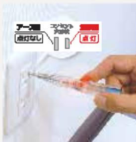
電気配線、コンセントの通電チェック、およびAC活線側/アース側の極性判別。
