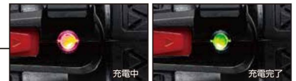
※回路保護のため、電動使用時に2N・m以上の負荷がかかると、赤色に点滅し動作が停止します。また、充電が15%以下になると同様に赤色に点滅します。
