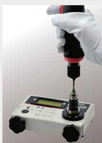
電動ドライバーの測定向きピークホールドモードと、トルクレンチなどの手動工具向きピークダウンホールドモードの2種類測定モードを選択できます。
