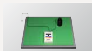
接地/接地可能接続点間抵抗の測定
