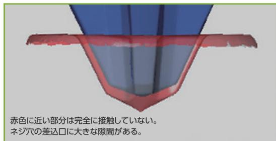
ネジ合わせで製作したビットを三次元測定器を用いてネジ穴との嵌合を確認する。
