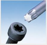
基本形状は、6つの耳たぶ状曲線で構成されています。六角頭と比べ駆動効率が高く、確実なトルク伝達とカムアウトが解消されます。
