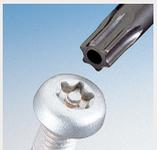
ネジのリセス中央部に「突起」を設け、通常のトルクスドライバーやマイナスドライバーでは差し込めない仕様になっています。タンパープルーフ・トルクスネジは、主に通信機器やコンピュータなどの「製品の設計上や管理上いじってはいけないところ」に使用されています。
