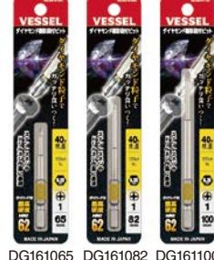
●刃先先端にダイヤモンド粒子をコーティング、ネジに食いつく。●全身無電解ニッケルメッキでビットをサビから守る。●マグネットなしで、精密ネジ作業に最適。●段付刃先でネジ頭や打込み箇所が見やすい。●ビット新素材・ダイハード鋼、強さと粘りが違う、最高硬度HRC62。
