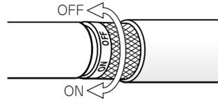
3. スロットル部及び回転部は細かい調整がしてあるので、絶対にさわらないようにお願いします。本機は精密部品を内蔵していますから、当てたり、落としたり、また本体外径をクランプして使用すると、回転不良となり寿命を低下させますので、絶対に避けてください。また、万一不調のときは、ご返送いただければ調整・修理いたします。
