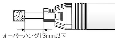
3. 再び、コレットシャフトをスパナ(対辺9mm)で固定し、コレットチャックをスパナ(対辺5mm)で強く締め付けてください。
