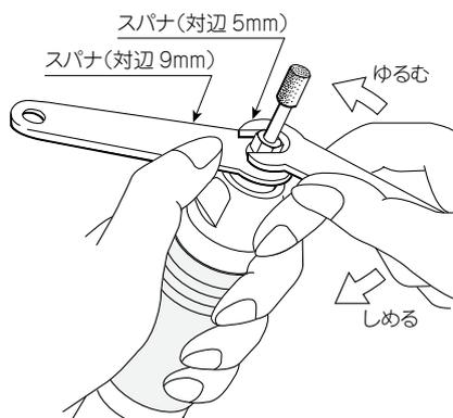
2. 次に研削砥石を挿入します。この時、砥石のオーバーハングは下図のように13mm以下になるようにしてください。
