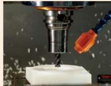
ノズル単品は、専用アダプター付き。はずすとM10メネジなので装置のエアアーノズルとしても使えます。
