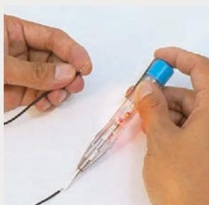
配線回路の導通チェック。(50MΩ以下の回路に限ります。)
