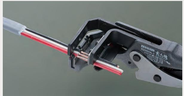
VA線・エコ電線の専用ストリッパー (VVF/EM-EFF)
