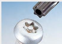
ネジのリセス中央部に「突起」を設け、通常のトルクスドライバーやマイナスドライバーでは差し込めない仕様になっています。タンパープルーフ・トルクスネジは、主に通信機器やコンピュータなどの「製品の設計上や管理上いじってはいけないところ」に使用されています。
