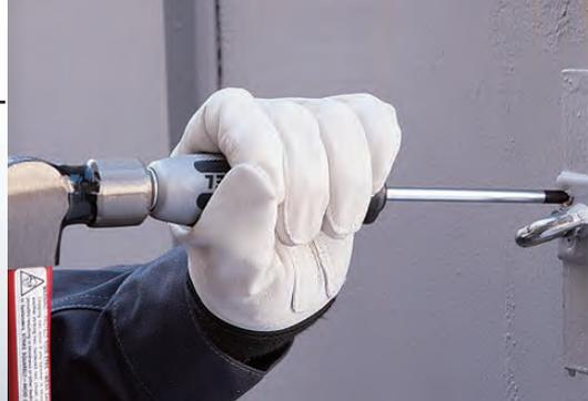
貫通ナットにカム回転構造を取り入れた独自設計でハンマーで叩くと刃先が瞬間的に約12°逆回転。刃先には衝撃加速度が加わるので、固着したネジ・錆びついたネジ・つぶれたネジも簡単に緩めることができます。
