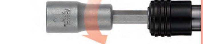
ソケット部と軸部をそれぞれに最適な硬度で熱処理しドッキング(圧入)。
