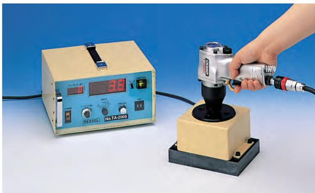
締めつけツールの出力管理、トルクレンチの精度確認に効果的です。インパクトツールの測定は、適正測定範囲の70%以内でご使用ください。
