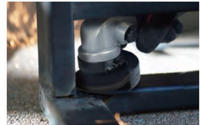
溶接部の仕上げ研磨
