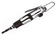
ギアで回転数を落とし、回転トルクを上げ、その力をネジに伝えます。
