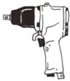
エアモーターの回転力を打撃部（衝撃部）に伝え、ハンマーでアンビルを打撃する。そしてその力をボルト・ナットに伝えます。エアドライバーでも同じ機構のものがあります。
