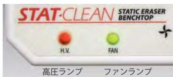
2色LEDを用いた運転状況確認ランプ。電源を入れると緑色に点灯し、正常に動作していることを確認できます。異常が発生すると、赤色に点灯。アラーム信号は外部に出力することができます。
