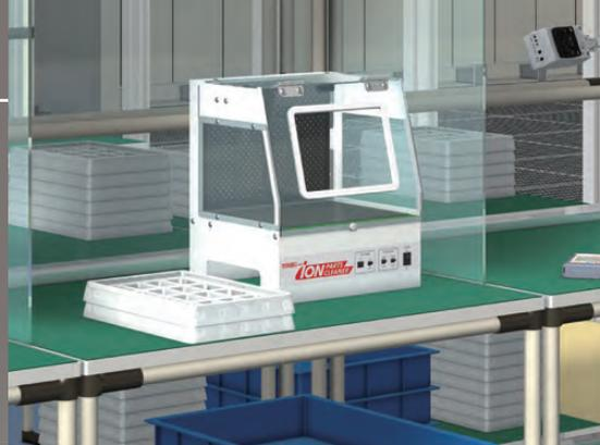
新発想、独自の粘着ゲルを使ったホコリ捕集方式により、集塵機やダクトなどの設置スペースが不要になります。また粘着ゲルフィルターは水洗いで何度でも使用できます。
