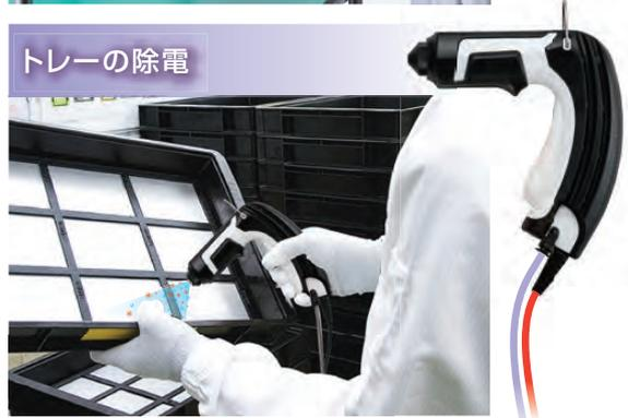
**No. N-1 静電気除去スーパースリムノズル**
