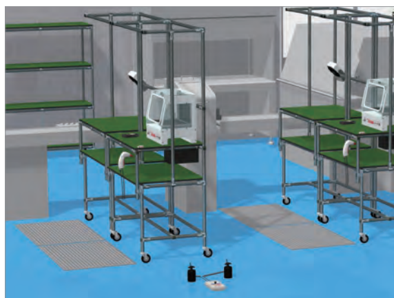
静電気対策エリア
