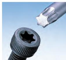
基本形状は、6つの耳たぶ状曲線で構成されています。六角頭に比べ駆動効率が高く、確実なトルク伝達とカムアウトが解消されます。
