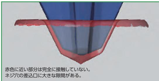
ネジ合わせで製作したビットを三次元測定器を用いてネジ穴とのかん合を確認する。
